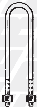
1 - 723955 \varnothing 24x130x290 2 - 723235 \varnothing 24x130x315
